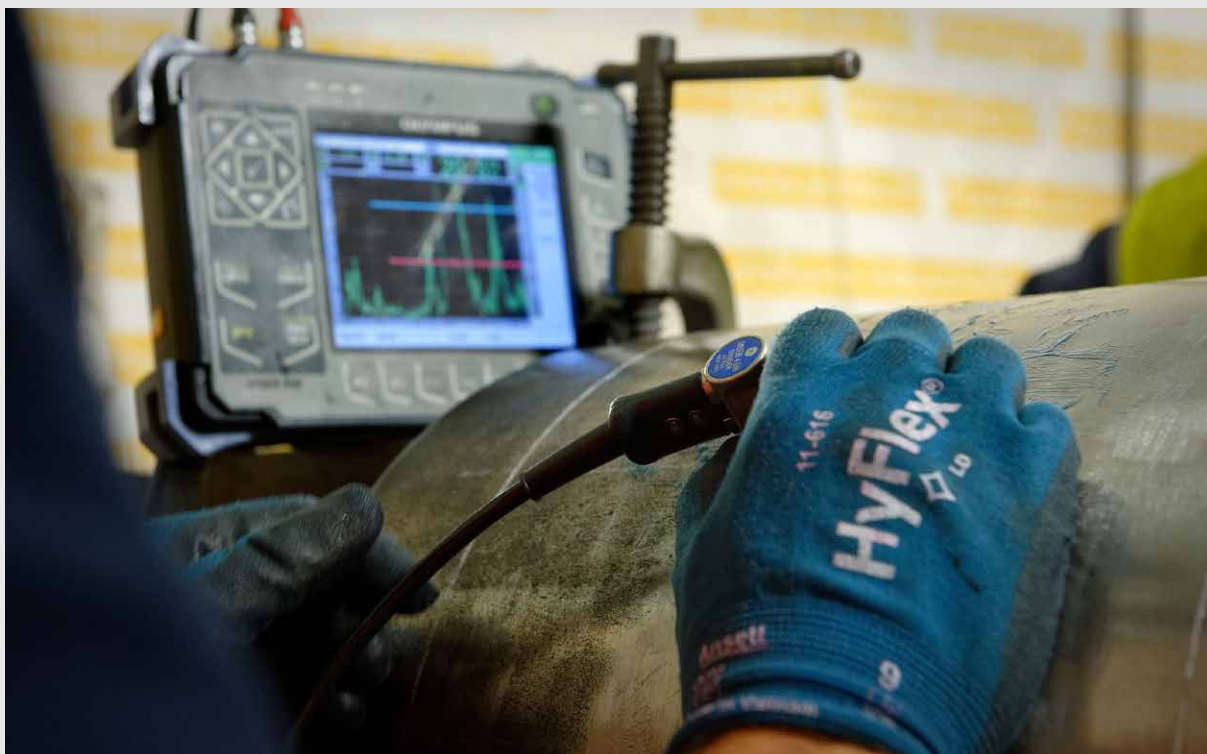
EXAMEN PAR ULTRASONS DE SOUDURES
