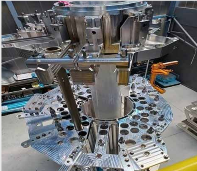
MONTAGE USINE DU RÉFLECTEUR DU RJH
